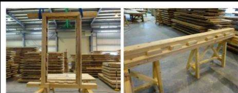
写真2.1 軸材フレーム
