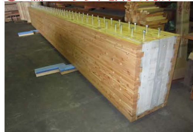
⑥ 燃エンウッド部材の完成
